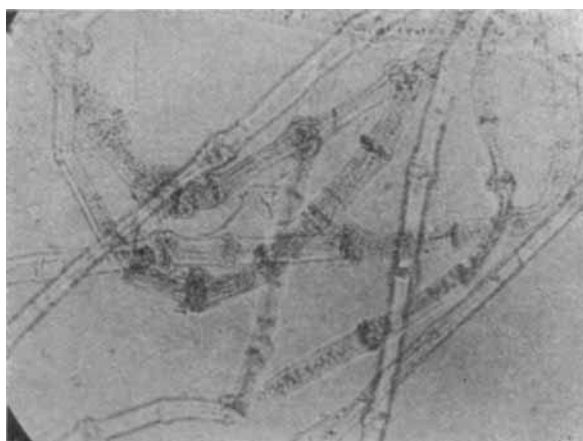
Abb. 2. Dieselbe Leinenfaser nach 50maliger Wäsche mit Wasser von etwa 8 bis 10 deutschen Härtegraden.
